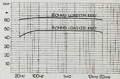
Uitgangsvermogen als functie van de frequentie (beide kanalen tegelijk, 0,2% vervorming).
